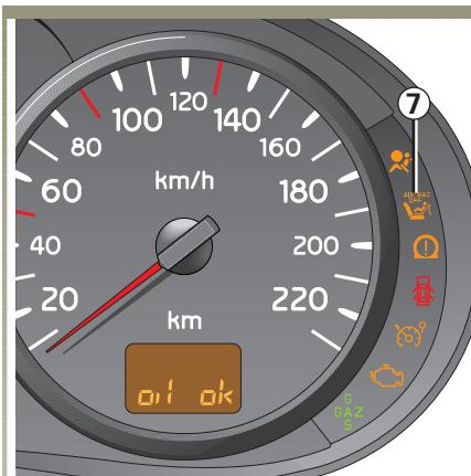
Zapnite zapaľovanie a **bezpodmienečne** sa presvedčte, či je kontrolka 7, AIRBAG OFF, rozsvietená na prístrojovej doske.
