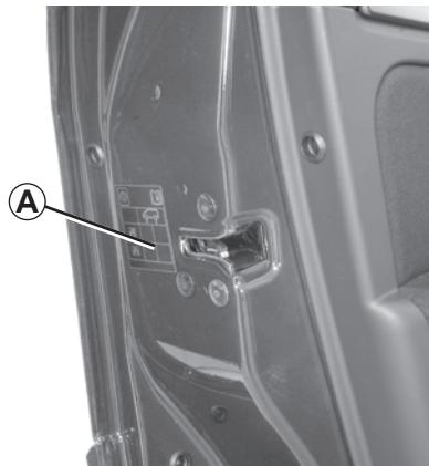
**A:** tlak vzduchu v pneumatikách je vyznačený na štítku **A** umiestnenom na ráme dverí vodiča. Aby ste ho mohli prečítať, je potrebné otvoriť dvere.
