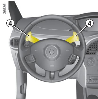
Kedykoľvek môžete zmeniť zvolený prevodový stupeň pomocou páčok 4 (v závislosti od vozidla). Displej na prístrojovej doske počas niekolkých sekúnd zobrazí zaradený nový prevodový stupeň a potom znova zočasí D.
