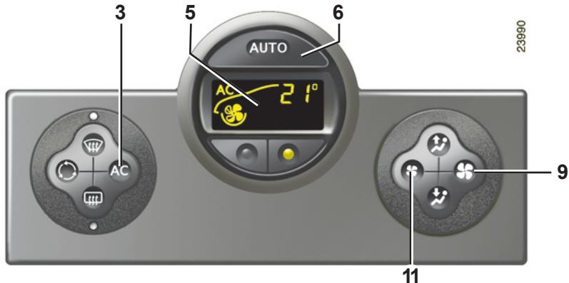
**Poznámka:** funkcia „rýchle odhmlievanie“ automaticky spúšta klimatizáciu (kontrolka svieti). Do automatického režimu sa vrátite opäťovným stlačením tlačidla **6**.
