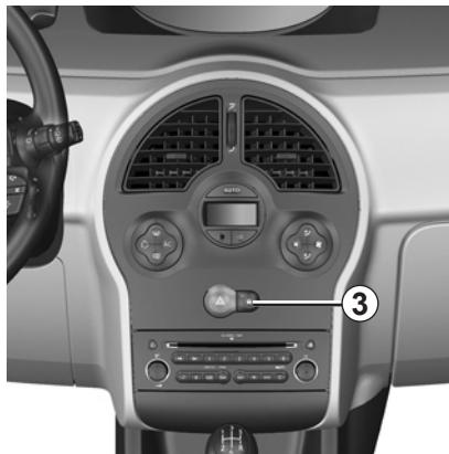
Zamknutie vozidla s otvorenými dvermi (preprava predmetov v otvorenom batožinovom priestore...), alebo ak sa nachádzate v oblasti so silným elektromagnetickým žiareniom, alebo pri poruche kľúča: vypnite motor a na viac ako päť sekúnd stlačte tlačidlo **3**.
