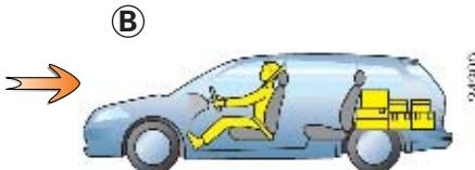
Ak potrebujete položiť na sklopené operadlo náklad, bezpodmienečne zatlačte opierky hlavy nadol, skôr ako sklopíte operadlo, aby ste mohli opriť operadlo čo najpevnejšie o sedák.
