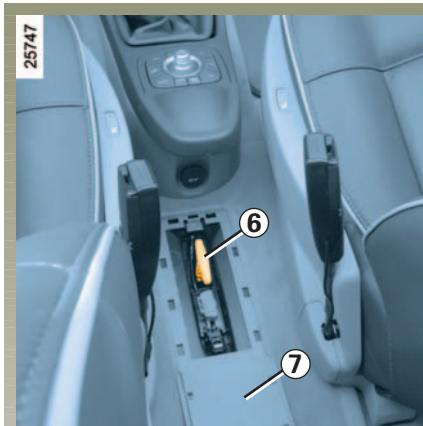
**Núdzové odomknutie**(porucha akumulátora alebo systému).
