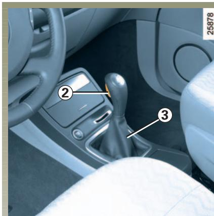
Ak je volič prevodov po naštartovaní zablokovaný v polohe P, pri stlačení brzdrového pedála ho možno uvoľniť aj manuálne. Odopnite vrchnú časť krycieho vaku 3.
